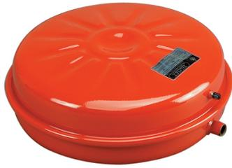
Corps acier laqué rouge. Raccord M acier. Membrane SBR. Pression de service 3 bar. Pression d'épreuve 4,5 bar. Température d'utilisation maxi +90°C. Pré gonflage usine : 1 bar.
