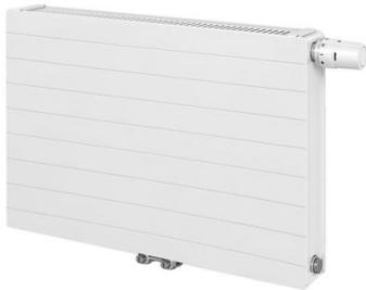
Face avant décorative rainurée. Radiateurs avec étriers et consoles de fixations incluses. Raccordement : 15x21 portée plate femelle et 2 orifices CENTRAUX 20x27 eurocône portée conique mâle. Pression de service max. : 10 bar. Epaisseur 63mm. Température à Delta T50.
