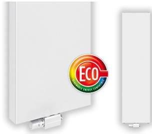
Radiateur horizontal à eau chaude avec face plane en tôle d'acier. Dispose de six entrées/sorties dont quatre de diamètre 15/21 et deux de diamètre 20/27 pour tube PER, acier ou cuivre. Intègre un système de raccordement central par canne en T adaptée à des installations mono ou bitube. Livré avec un insert thermostatique, bouchon de vidange et de purge, grille et joues latérales.
