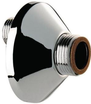
Raccord décalé standard. M1/2" - M3/4". Entraxe 11 mm, L.50 mm. Rosace Ø 70. Laiton massif. Livré par 2 pièces. Garantie 10 ans.
