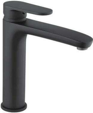
Mitigeur lavabo bec haut. Manette en métal. Cartouche diamètre 35 mm. Limiteur de débit : Economie d'eau grâce à la butée à 50% du débit. Entretien facile : mousseur anticalcaire. Hauteur totale : 203.5 mm, hauteur sous bec 149.5 mm, longueur bec 150mm. ECAU : E0 C3 A2 U3
