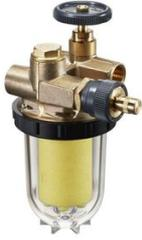
Robinet d'arrêt à fermeture rapide. Élément filtrant en tamis nickelé 100-50 m. Raccordement femelle 12x17 pour raccords de bourrage 6, 8, 10 ou 12 mm. Débit 500L/h. Livré sans raccords. Corps laiton.
