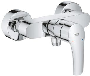
Couleur: Chromé. Montage mural apparent. Levier de commande métallique. GROHE SilkMove Cartouche en céramique C2 35mm avec butée 1/2 débit. Limiteur de débit ajustable. Limiteur de température. GROHE Brillance Longue Durée. Clapet anti-retour intégré dans le départ douche 1/2". Raccords en S. Rosaces métalliques. Protégé contre les retours d'eau.
