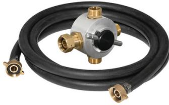
Complet avec tuyau tissé en EPDM 1/2 T100. Pour le rinçage des systèmes de chauffage par le sol ou par les murs et pour l'élimination efficace des dépôts par des impulsions de pression lors du changement de direction du flux.
