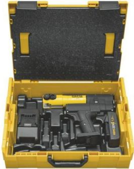
Pour l'entraînement de pinces à sertir Mini/boucles de sertissage REMS. Porte-pince à sertir pivotant avec verrouillage automatique. Entraînement électrohydraulique avec moteur à accu 21,6 V, 380 W, engrenage planétaire robuste, pompe à piston excen trique et système hydraulique compact et puissant, interrupteur à bouton- poussoir de sécurité. Lampe de travail LED. Accu Li-Ion 21,6 V, 1,5 Ah, chargeur rapide Li-Ion 230 V, 50?60 Hz, 70 W.
