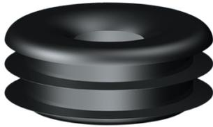
Raccord en caoutchouc. Pour Ø intérieur de goulotte de 55 mm et tube de descente de chasse de 28 à 37 mm.
