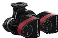
Circulateur à vitesse variable à haut rendement énergétique conforme à la directive ErP. Indice d'efficacité énergétique en dessous des exigences de la directive ErP pour 2015. Indication du fonctionnement et de défaut. Mode de régulation : 3 courbes régulation pression constante, 3 courbes régulation proportionnelle, 3 courbes constantes. Livré avec coquille d'isolation.
