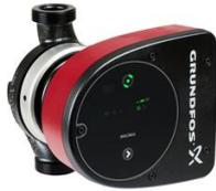
Circulateur à vitesse variable à haut rendement énergétique conforme à la directive ErP. Indice d'efficacité énergétique en dessous des exigences de la directive ErP pour 2015. Indication du fonctionnement et de défaut. Mode de régulation : 3 courbes régulation pression constante, 3 courbes régulation proportionnelle, 3 courbes constantes. Livré avec coquille d'isolation. Entraxe 180 mm.
