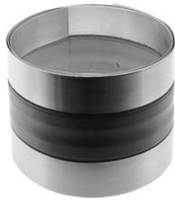
Le joint de dilatation se pose à la jonction entre deux parties d'une gouttière en zinc. Grâce à sa bande EPDM vulcanisée sur deux bandes de zinc, il permet de maîtriser les mouvements liés à la dilatation du métal. Placé entre 2 éléments de gouttière demi-ronde, il évite ainsi une détérioration de l'installation lors de variations de température.
