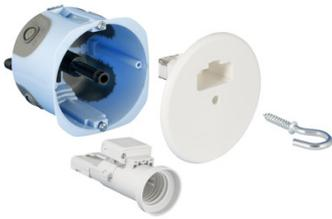
Boîte : Diamètre 67mm profondeur 50mm avec axe centrale solidaire à la boîte - Accepte gaine ICTA D16, D20 et D25.
