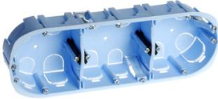
Diamètre 67mm. Profondeur 40mm. Entraxe de 71mm. Accepte gaine ICTA D16, D20 et D25
