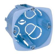
Diamètre 67mm. Profondeur 40mm. Accepte gaine ICTA D16, D20 et D25
