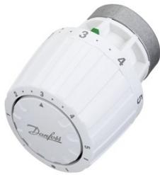
Utilisés pour remplacer les anciens thermostats Danfoss séries RAV (Emboîtement de 34 mm) et RAVL (Emboîtement de 26 mm) sans changer le corps de vanne. La forme et les caractéristiques techniques sont identiques à celles des vannes thermostatiques de la série RA 2000.
