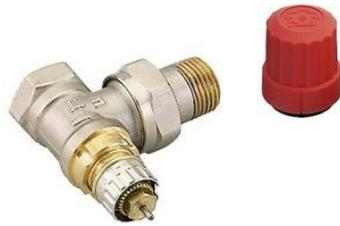
Confort et économies d'énergie. Assure en un tour de main et sans outillage spécial le bon débit du radiateur. Pour les installations bitube avec pompes de circulation. Limiteur de débit incorporé. Presse-étoupe remplaçable sans vidange.
