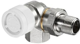
Robinet thermostatique Série AV 9, robinet d'angle, raccordement à gauche. Laiton nickelé. kvs: 0.9. Pression différentielle max.: 1 bar. Pression de service max.: 10 bar. Température de service max.: 120 ° C.
