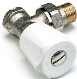
Robinet manuel double réglage. Débit qui se règle grâce à la clé COMAP 135. Permet d'avoir une fonction d'équilibrage supplémentaire par limitation du clapet. Robinet manuel EuroSar évolutif qui peut être thermostatizable (sauf pour la dimension 1??)
