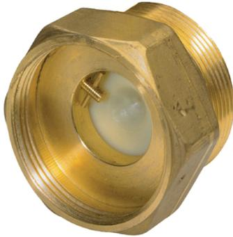
Montage direct sur circulateurs à unions débrayable pour vidange. Température maximum 130°C. Pression maximum : 10 bar. Pression d'ouverture : 0,02 bar.
