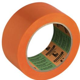
Support : PVC orange souple. Épaisseur totale : mini 125 microns. Usage général. Bonnes propriétés de déformation et d'adhésivité, même à basse température. Rouleau de 33 mètres x 48 mm.
