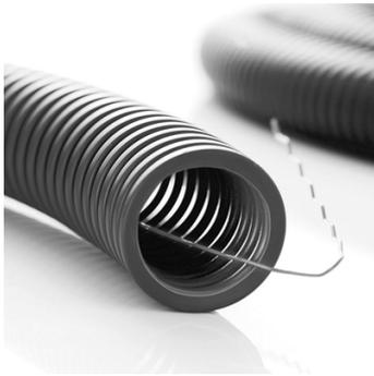
Avec tire-fils résistants et non rétractables en acier galvanisé. IK08 - Conduit seul : IP68 - Conduit + manchon : IP44. Couleur qui permet une identification aisée des circuits: bleu pour les courants forts, marron pour les circuits spécifiques et vert pour les courants faibles - ICTA : Isolant, Cintrable, Transversalement élastique, Annelé. Conduit non propagateur de flammes.
