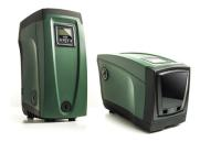
Surpresseur Intelligent à vitesse variable E.Sybox 40/80. Alimentation électrique : 230 V - 1,55 kW. 10 A. Débit max : 6,6 m³/h. Pression max : 5 bar. Raccordements 1' F.
