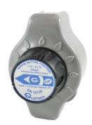
Se pose après la première détente. 3 fonctions : Robinet d'arrêt, détente et sécurité (coupure du débit en cas de chute dépression amont et excés de débit). Conforme aux normes NF M 88 773. Débit 1.3 kg/h. Pression amont 0.1 à 0.6 bar. Pression aval 28 mbar.
