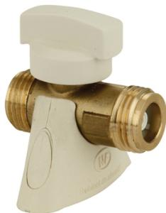
Corps monobloc. Filetage double mâle G 1/2, à Joint Plat Gaz, Méplat de serrage. Manette ergonomique haute résistance. Socle haute résistance : Pièce monobloc en POM indémontable. ROAI conforme à la norme NF ROB GAZ.
