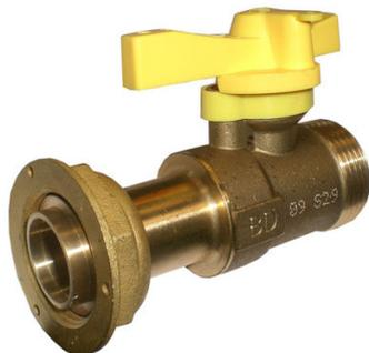
Pression maximale d'utilisation : 500 mbar. Filetage mâle et écrou prisonnier tournant femelle 6/20 à Joint Plat Compteur plombable. Pour compteur G4 (6 m<sup>3</sup>/h). Classe de température : - 20°C / + 60°C. Certifié NF ROB GAZ. Conforme NF EN 331. Pour compteur G4 (6 m<sup>3</sup>/h). Classe de température : - 20°C / + 60°C.
