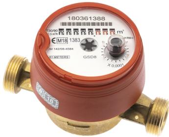
Compteur divisionnaire MID, modèle eau chaude, certifié ACS 4MS, corps en laiton, lecture directe sur 8 rouleaux, indice de protection IP68 pour réseaux de distribution d'eau.
