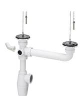
Départ joint conique  $\emptyset$  40. Garde d'eau 60 mm. Réglable en hauteur. Prise pour machine à laver. 2 bondes plastique blanc à chaînette.
