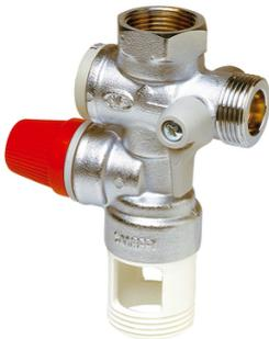
Protège les chauffe-eau jusqu'à une puissance de 10 kW. Corps chromé, vanne à sphère et clapet anti-retour en laiton. Pression de tarage de la soupape de sécurité: 7 bar. Agrée NF.
