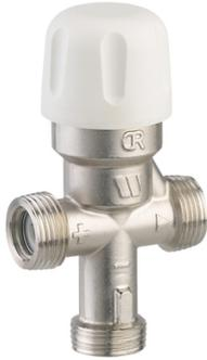
Sécurité intégrée immédiate en cas d'interruption de l'eau froide conformément aux normes EN1111 et EN1287 (avec clapets AR). Fournit une température d'eau mitigée stable. Chapeau clipsé libre protégeant d'un dérèglement de la température par l'utilisateur. Clapets anti-retour intégrés protégeant des mélanges d'eau intempéstifs. Plage de température réglable de 25° à 55°C. Débit 38 l/min à 3 bar.
