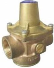
Normalisé NF EN 1567. Fonctionne en toutes positions. Pression amont maxi 16 bar. Pression aval réglable de 1 à 5,5 bar. Préréglé d'usine à 3 bar. Débit 2000 l/h en 15/21, 2800 l/h en 20/27 pour une perte de charge de 1 bar. Bouchon 1/4" de chaque côté permettant la pose d'un manomètre. Corps bronze.
