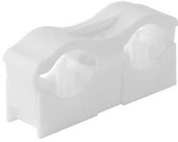
Un seul Collclip permet la fixation de tous les diamètres de tuyaux et gaines de 12 à 22 mm. Les ailettes souple-dure assurent le serrage idéal, absorbent la dilatation et les vibrations. Temps de pose réduits de 60%. Fixation définitive assurée par simple pression manuelle (pas de vissage, pas d'outillage) en polyamide haut module, isophonique.
